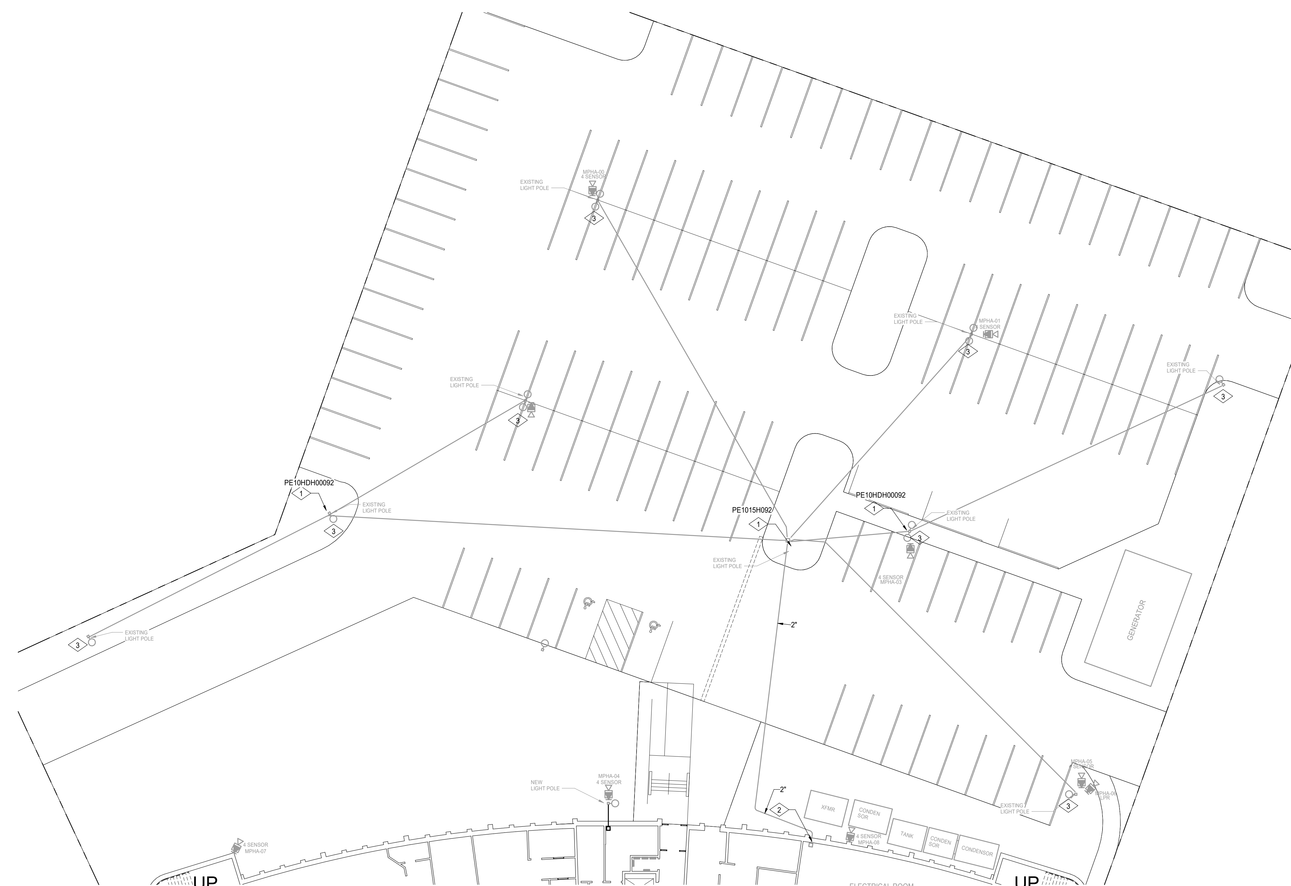
1 1001 WASHINGTON CONDUIT PLAN 1/16" = 1'-0"
